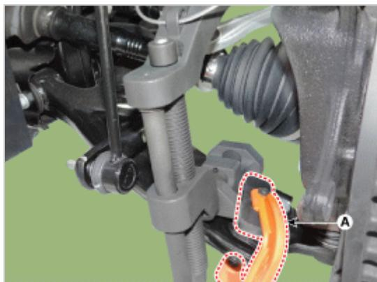
(7) 安装固定夹钳(A)后, 顺时针转动操作手柄(B), 直至固定夹钳固定在下臂上为止。
